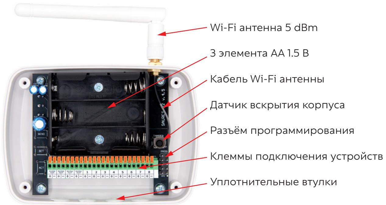
Резиновые втулки могут быть заменены гермоводами диаметром 8 мм.
