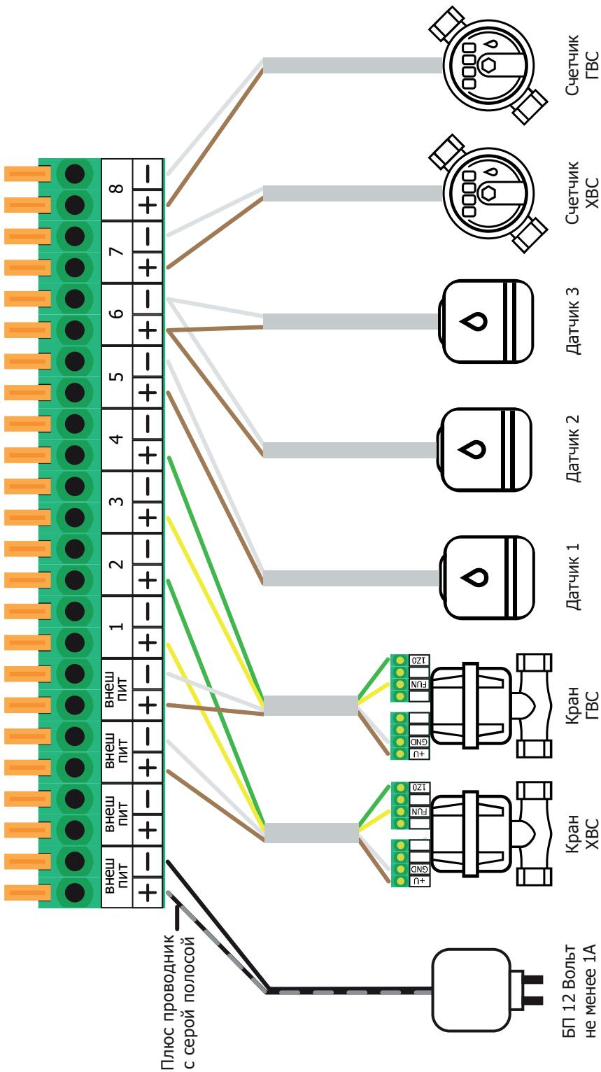
Обратите внимание, что к шестому каналу датчики протечки подключены параллельно. Если не используется подключение счетчиков, то свободившиеся каналы могут использоваться для раздельного подключения к ним датчиков протечки.
