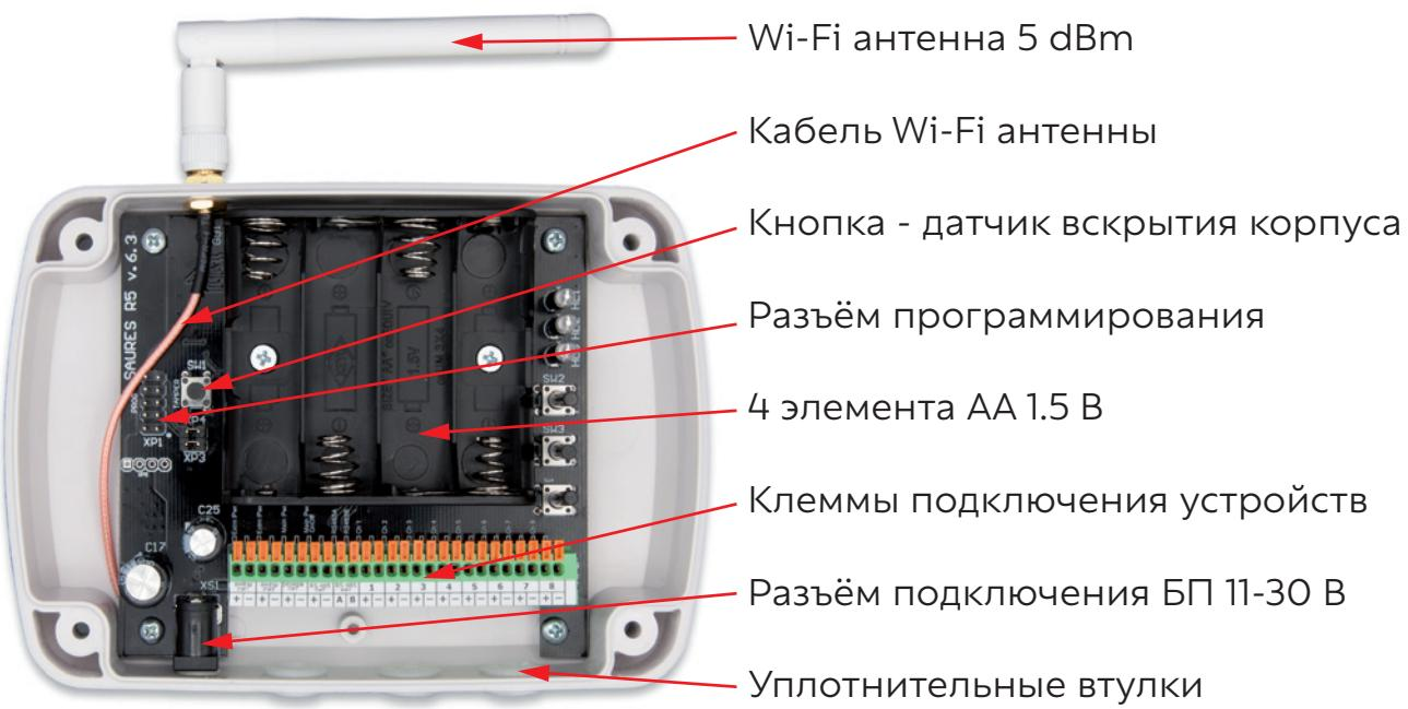
Резиновые втулки могут быть заменены кабельными вводами диаметром 8 мм. Кабельную сборку можно заменить на более длинную, до 50 см., для выноса антенны Wi-Fi.
