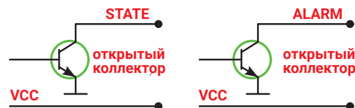
Рис. 8. Выходные каскады STATE и ALARM блока управления
