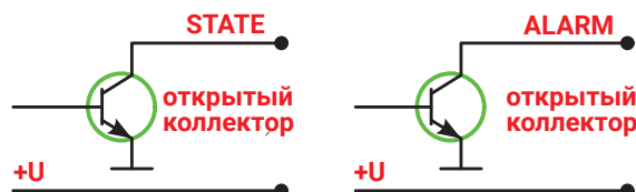
Рис. 6. Выходные каскады STATE и ALARM блока управления
