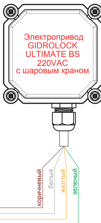
Рис. 4. Схема подключения шарового электропривода на напряжение питания 220 В
