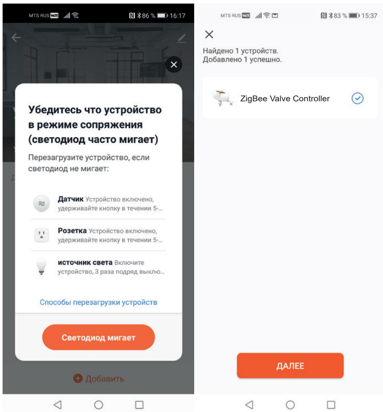
13. управление умным манипулятором возможно осуществлять нажатием центральной кнопки на экране добавленного устройства «Zigbee Valve Controller».
