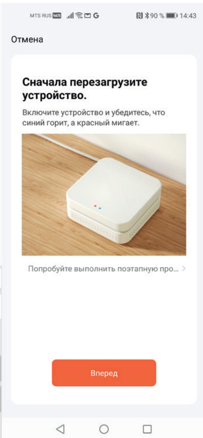
7. Проверьте состояние светового индикатора на подключаемом шлюзе Zigbee и нажмите кнопку на экране мобильного приложения соответствующую скорости мигания индикатора на шлюзе.
