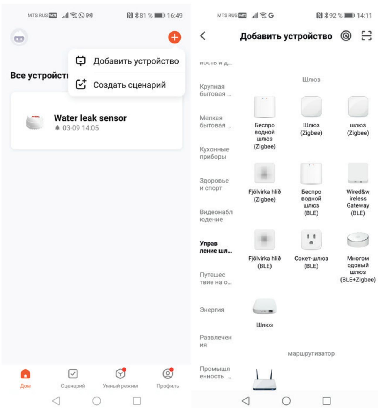
5. При подключении беспроводного шлюза Zigbee мобильное приложение потребует ввести имя Wi-Fi сети, к которой в дальнейшем будет подключаться беспроводной шлюз Zigbee и пароль для доступа.
